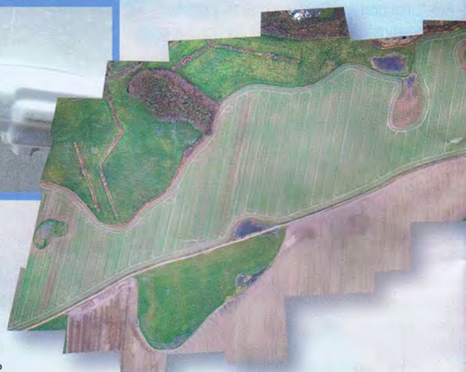
Die Agrar-Drohne von CiS lässt sich auch vom Modellflug-Laien sicher in die Luft bringen und wieder landen. Bestückt mit einer oder zwei Kameras erkundet sie die Flächen. Aus den Bildern lässt sich die Verteilung der Biomasse ermitteln. Fotos: Böhrnsen
