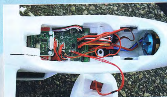
Die gesamte Elektronik ist im Cockpit der Agrar-Drohne untergebracht. Der Autopilot nutzt einen elektronischen Kreiselkompass und kann damit sogar starten und landen.
