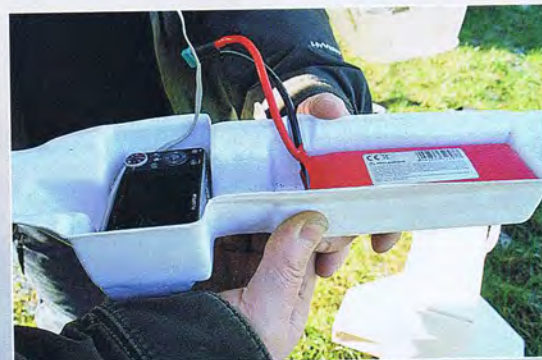
In den Laderaum passen der Akku und die Kamera exakt hinein. Auf Wunsch bietet CiS auch eine Schale für zwei Kameras an. Auf der stabilen Schale landet das Flugzeug auch.
