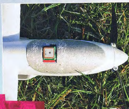
Das Modellflugzeug vom Typ Multiplex EasyGlider Pro ist mit einem 4-Hz-GPS-Empfänger ausgestattet.
